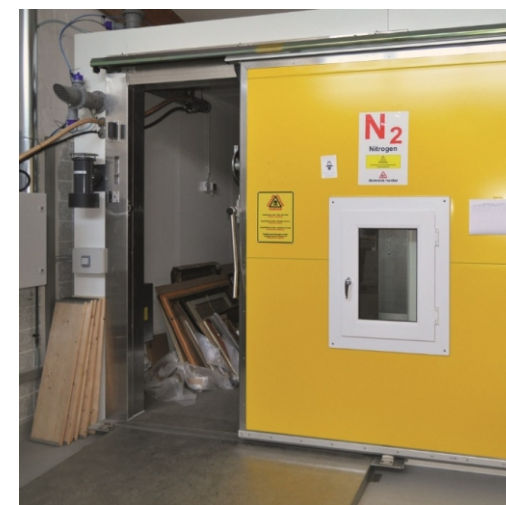
Câmara de nitrogênio para anóxia.
