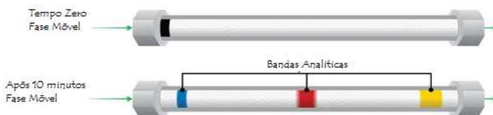
**Figura 4** – Ilustração da separação analítica de tres componentes de uma mistura.
