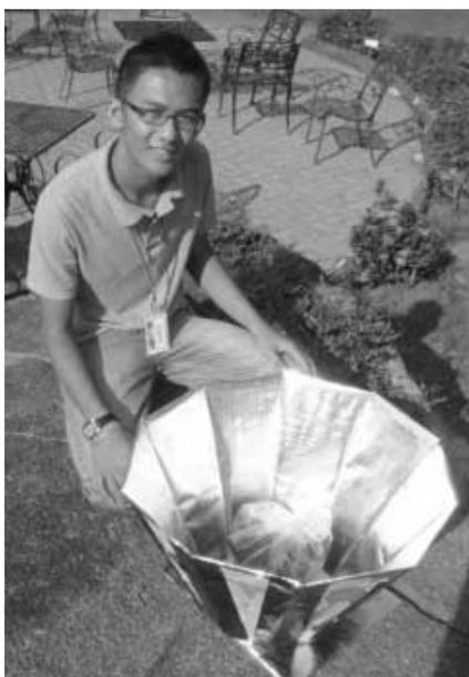
Uma painela solar utiliza a energia do Sol para cozinhar alimentos. Uma parte essencial de todas as painelas solares é o refletor. Trata-se de uma superfície brilhante que reflita e concentre a energia do Sol. Existem vários formatos possíveis, mas a maioria utiliza o formato de tigela.
