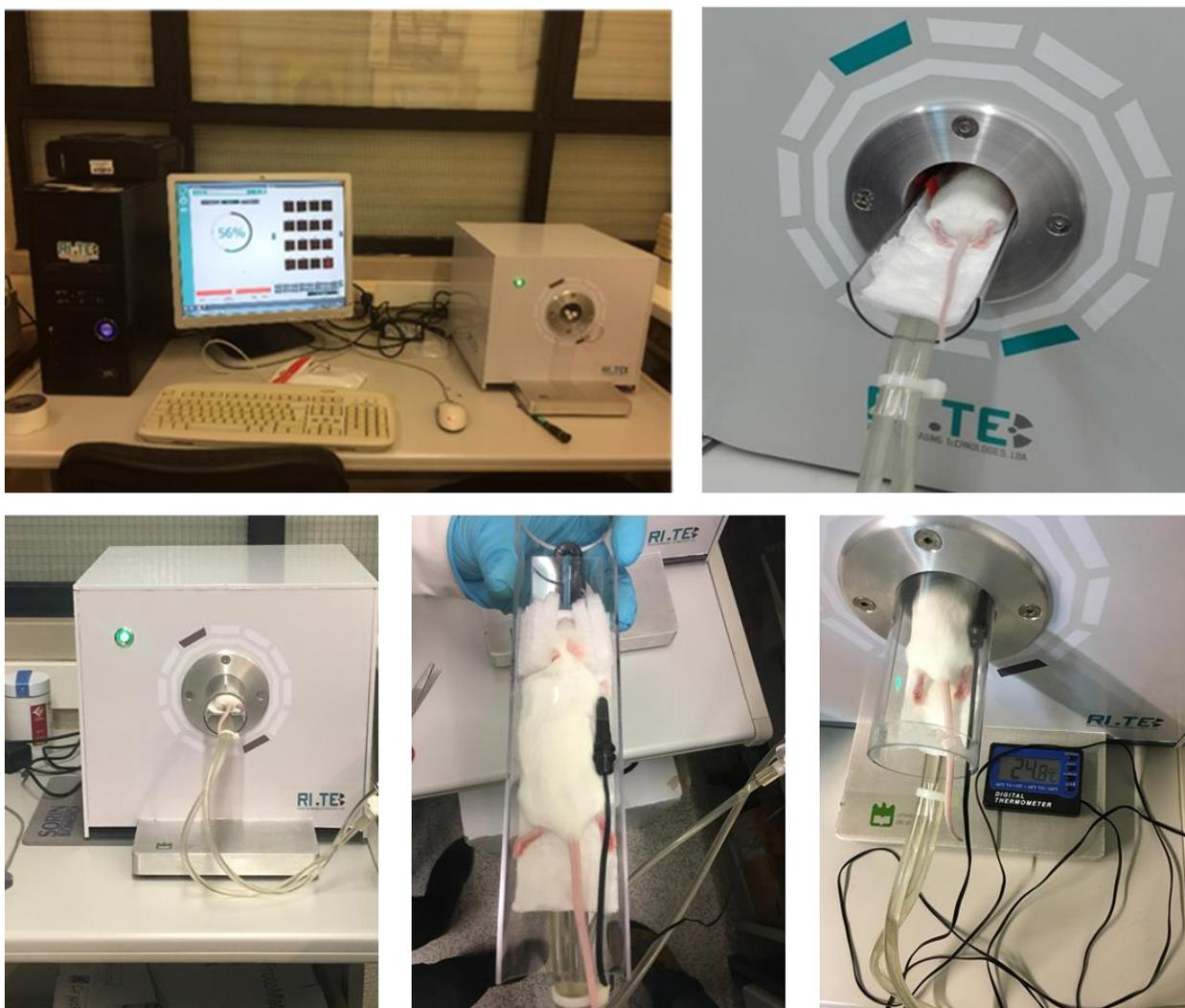
**Figura 9: EasyPET-3D.** Equipamento utilizado para avaliação da atividade metabólica de áreas cerebrais de pequenos animais. Fonte: arquivo pessoal.
