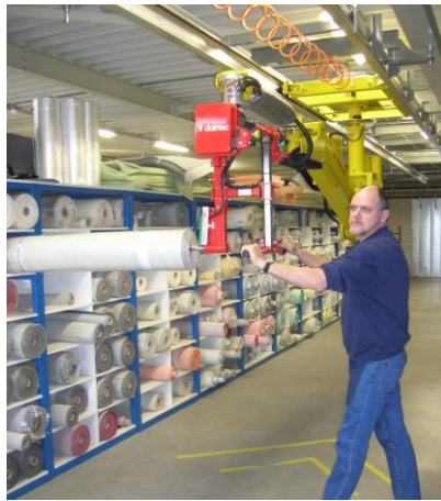
Imagem 1 - Modelo de braço mecânico utilizado em indústria têxtil (fonte: https://www.dalmecc.com/pneumatic-manipulator-rolls-of-cloth/ )
