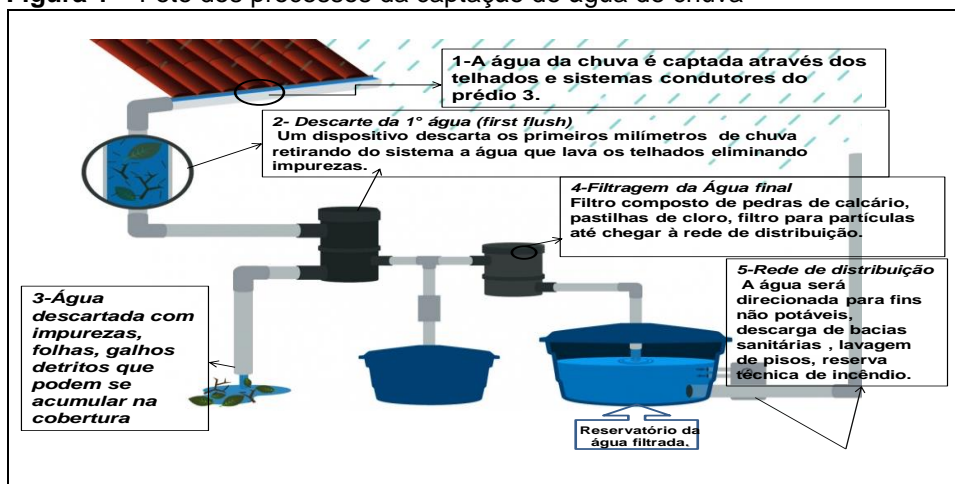
Figura 1 – Foto dos processos da captação de água de chuva
