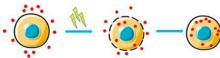
Figura 3. Mecanismo de entrega físico via eletroporação. (adaptado de LIU et al., 2017).
