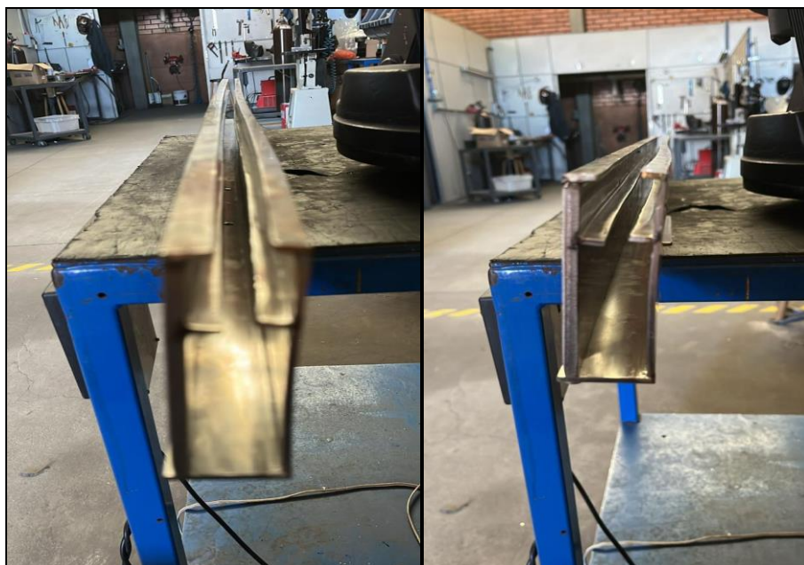
Figura 04: Calha vibratória fabricada em aço inox 316L
