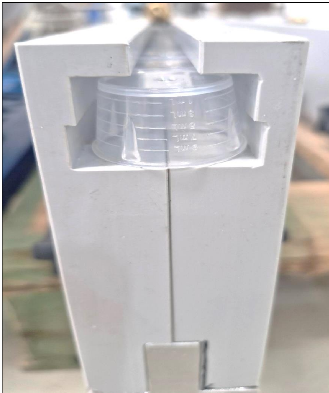
Figura 7: Calha transportadora em PET-P TX com o copo dosador
