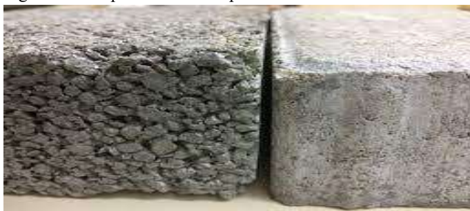
Figura 4: Comparativo asfalto permeável x asfalto convencional
