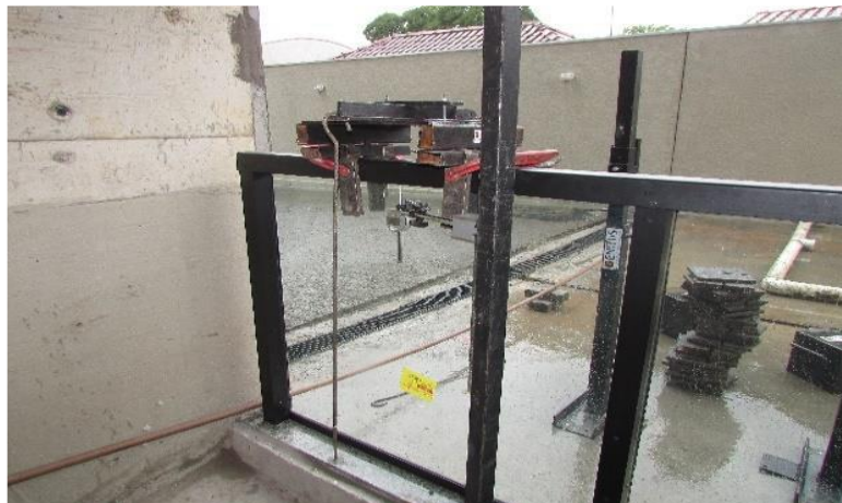
Figura 13: Base instalada no centro do módulo para o esforço estático vertical
