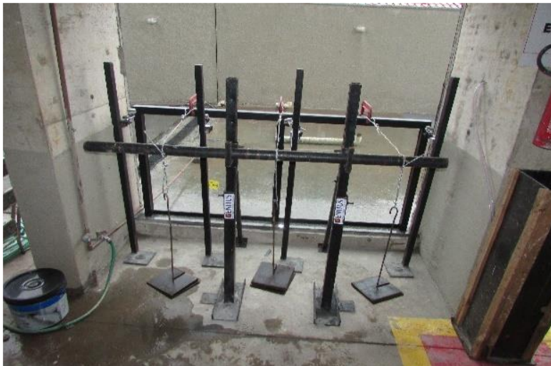
Figura 7: Aplicação da pré-carga durante esforço estático horizontal de fora para dentro
