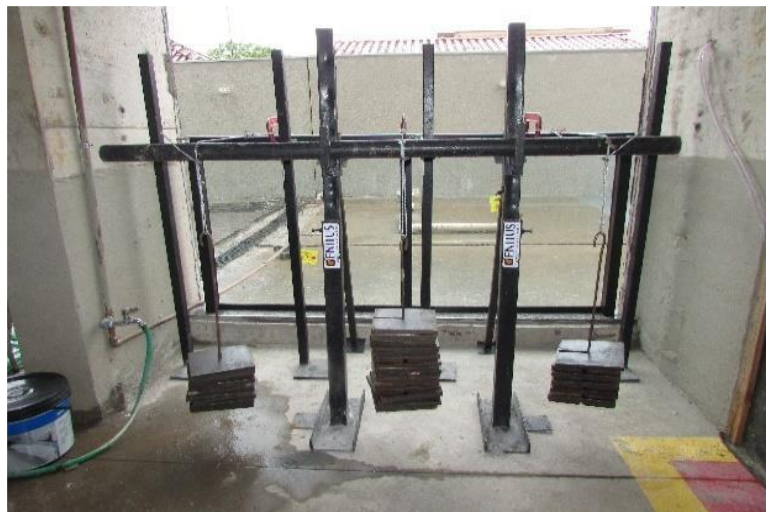
Figura 8: Aplicação da carga de uso durante esforço estático horizontal de fora para dentro
