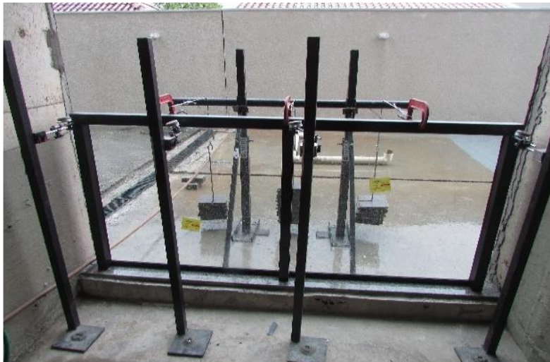
Figura 10: Aplicação da pré-carga durante esforço estático horizontal de dentro para fora
