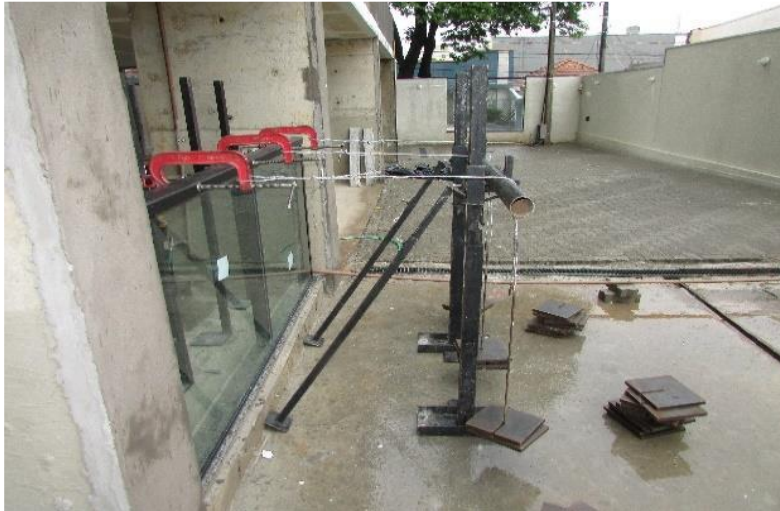
Figura 9: Aplicação da pré-carga durante esforço estático horizontal de dentro para fora
