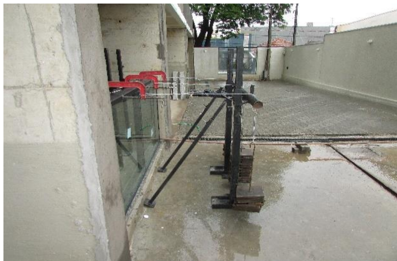
Figura 11: Aplicação da carga de uso durante esforço estático horizontal de dentro para fora
