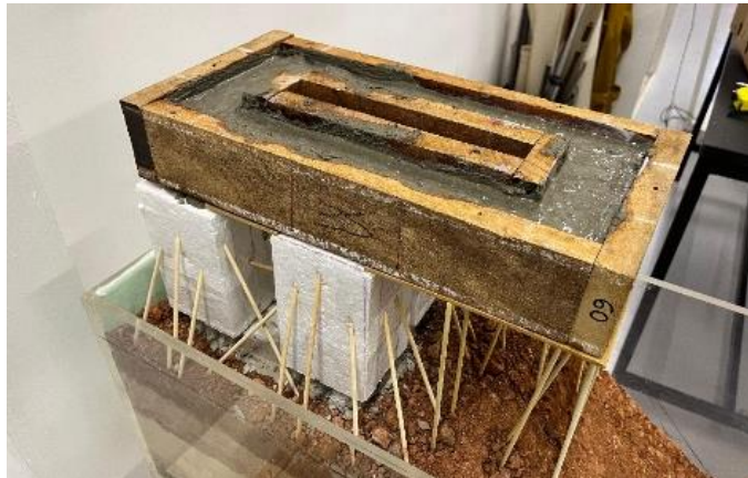
Figura 13 – Concretagem das vigas superior (Fonte: Próprio autor).
