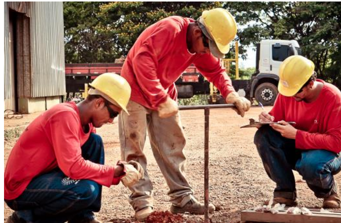
Figura 3 – Sondagem a trado (Fonte: https://blog.apl.eng.br/conheca-e-entenda-os-procedimentos-executivos-da-sondagem-a-trado/ ).
