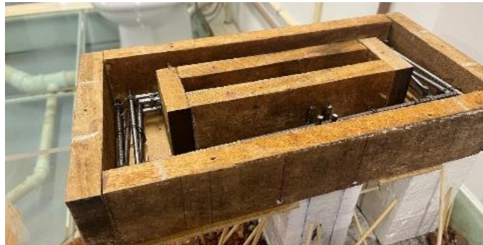
Figura 12 – Armaduras das vigas superior (Fonte: Próprio autor).
