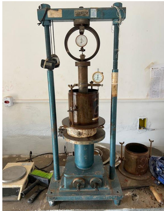
Figura 23: Corpo de prova na Prensa CBR Manual Fonte: Próprios autores.
