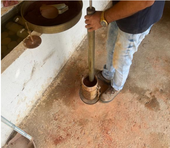
Figura 18: Compactação das camadas no cilindro Fonte: Próprios autores.
