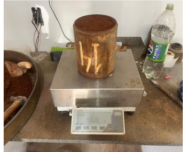
Figura 19: Pesagem do cilindro com solo compactado Fonte: Próprios autores.
