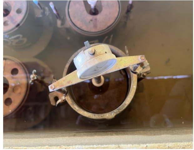
Figura 22: Corpo de prova submerso com relógio comparador Fonte: Próprios autores.
