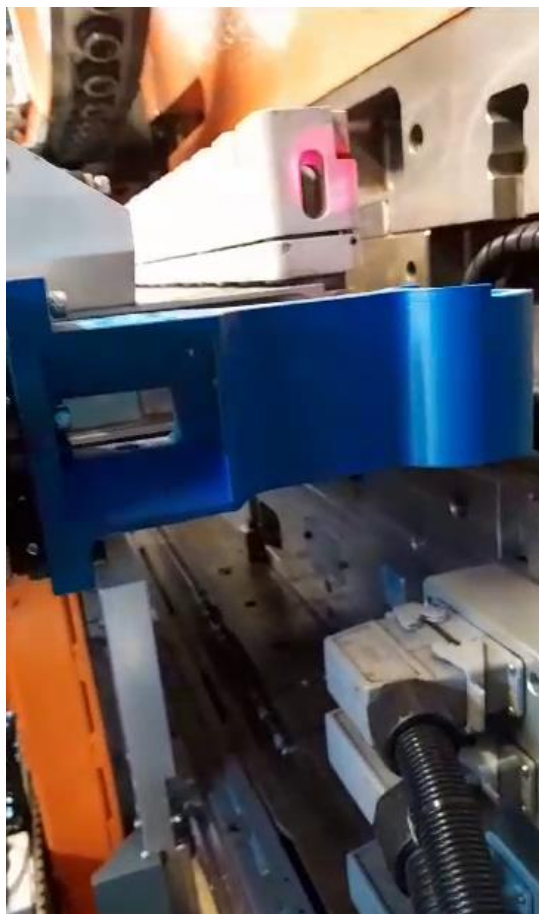
Figura 16. Teste de validação geométrica em máquina com PLA.
