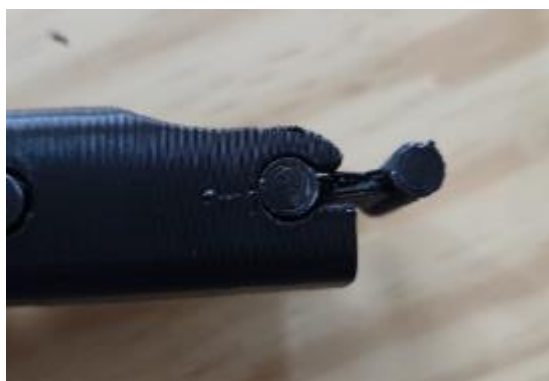
Figura 20: Articulação impressa com diâmetro maior
