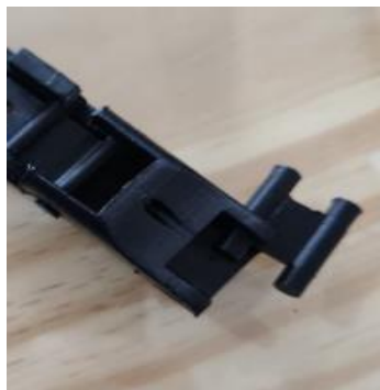
Figura 19: Articulação impressa com diâmetro menor
