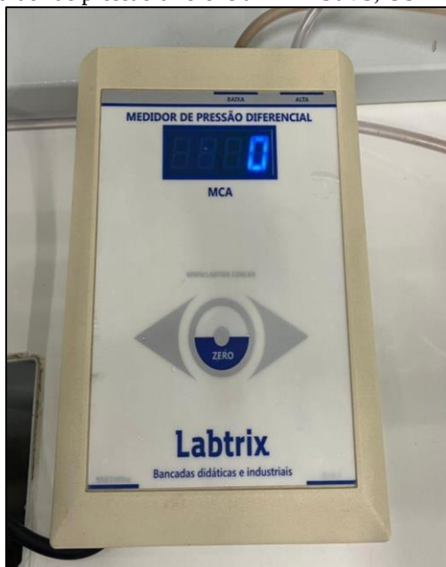
Figura 6 – Medidor de pressão diferencial MDD30V3, USF Itatiba, São Paulo
