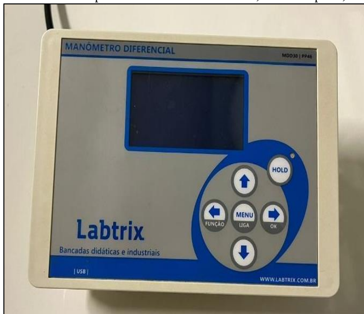
Figura 5 – Medidor de pressão diferencial MDD30V2, USF Campinas, São Paulo
