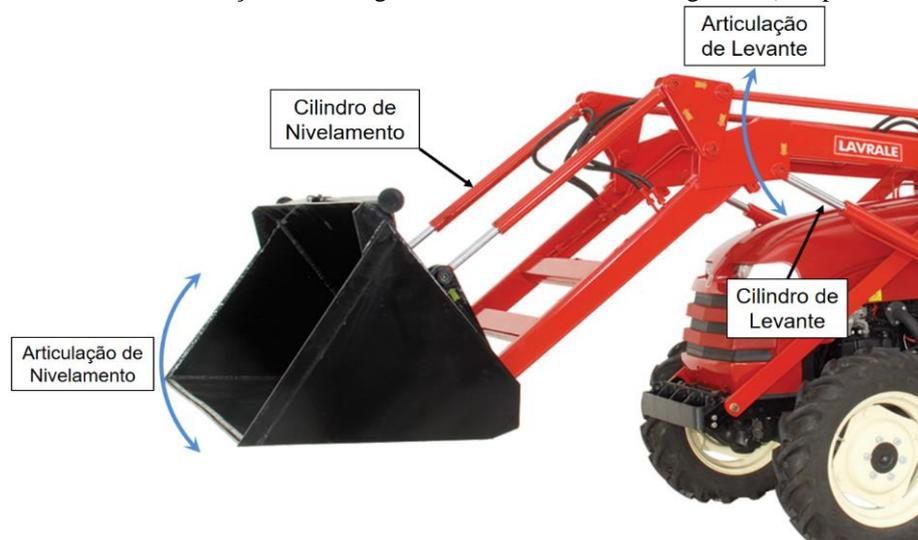
Pela análise da Figura 2 é possível visualizar que a articulação de nivelamento tem por objetivo ajustar o posicionamento da pá da carregadeira frontal, já a articulação de levante tem por objetivo realizar o giro do braço que implica na regulagem de altura do conjunto da pá.
