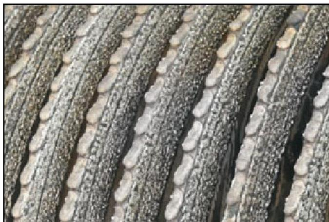
A soldagem de chapisco pode ser realizada através de um sistema automatizado que utiliza o arame tubular (Flux-Cored Arc Welding – FCAW) ou manualmente com o eletrodo revestido. No processo automatizado, faz-se o uso de bitolas de arame tubular que variam o tamanho do seu diâmetro de 2,8 a 3,2 mm, e no processo manual o diâmetro varia entre 4 a 7
