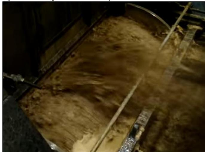
O processo de moagem, indicado pela Figura 3 ocorre desde o primeiro até o último terno, nos dois primeiros ternos é obtido o caldo primário, que usualmente é utilizado para a produção de açúcar. Nos ternos seguintes, é feito o processo de embebição do bagaço, onde são aplicados jatos de água a 60 °C para que aumente a diluição do caldo contido no bagaço. Nesta operação, é obtido o caldo secundário ou misto, que é destinado à produção de álcool (SANTOS, 2017).
