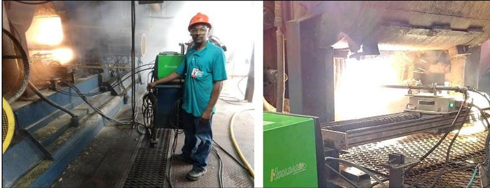
Para a realização da soldagem automática, a execução da programação do robô é efetuada por um operador, que através de um controle, efetua o alinhamento das tochas no primeiro friso do rolo, posicionando as mesmas para que sejam chapiscados os dois lados do friso ao mesmo tempo. Em seguida, o robô opera de forma automática até o último friso do rolo a ser chapiscado.
