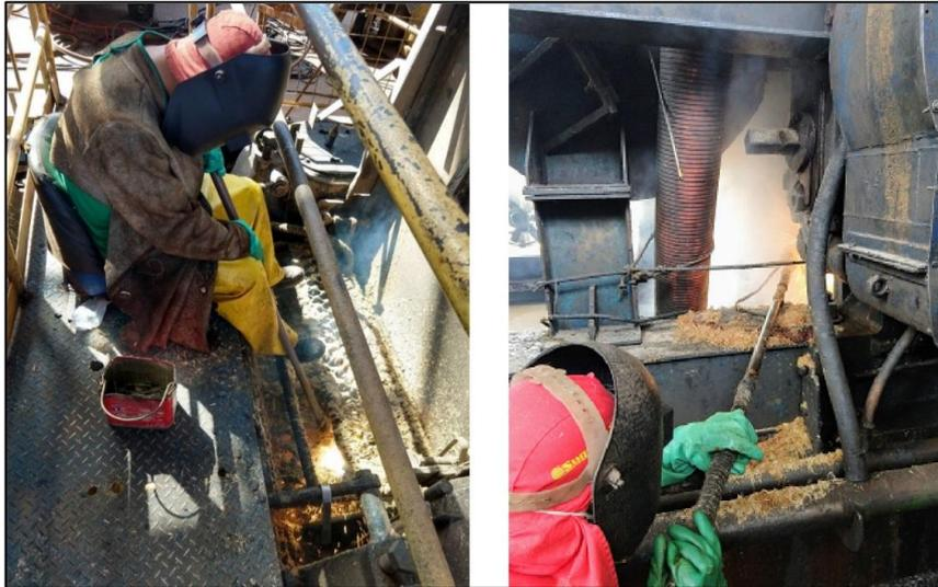
Neste método, o operador deve respeitar o tempo ideal de queima do eletrodo, que varia entre 3,5 a 4 minutos cada um. Esse parâmetro de tempo é estipulado pela regulagem da corrente e tensão na fonte de solda (UNIWELD IND. DE ELETRODOS LTDA, 2018).
