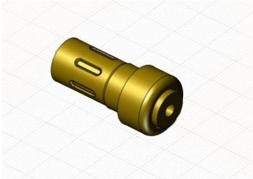
O tubete utilizado foi removido de uma válvula termostática automotiva da marca MTE THOMSON modelo VT288.80 que originalmente tem atuação entre 80 e 86°C, a haste que acompanha a válvula e fica inserida no tubete foi removida e deu lugar a haste do tampão da válvula de retenção (que foi usinado nas mesmas dimensões da haste que trabalha no tubete), a seguir é possível observar o conjunto com o tampão da válvula de retenção já usinado e a mola de retorno.
