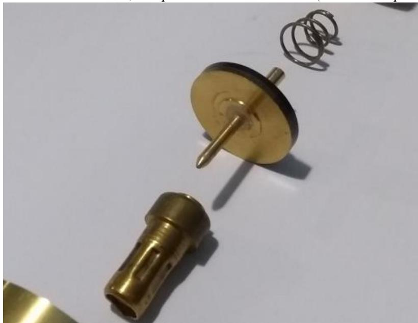
Para alojar o conjunto foi utilizado uma válvula de retenção de diâmetro 1” em latão da marca Double-Lin. Este modelo de válvula é originalmente normal fechada e seu controle é realizado por mola. Foi realizada uma alteração na qual a válvula passou a atuar em condição normal aberta e o sentido de fluxo foi invertido.
