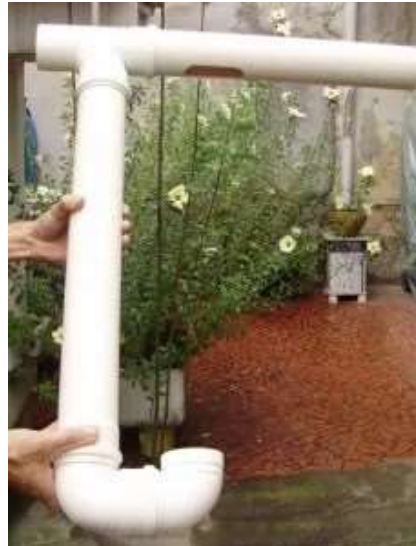
Imagem 4 – Redutor de turbulencia (Fonte: Internet)
