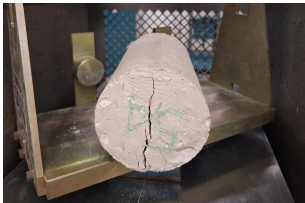
Figura 17 - Foto do ensaio de tração por compressão na diametral do traço de concreto com fibra de coco (Fonte: Próprios Autores).
