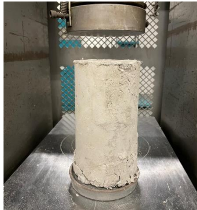
Figura 12 - Foto do ensaio de compressão do traço de concreto com fibra de polipropileno (Fonte: Próprios Autores).
