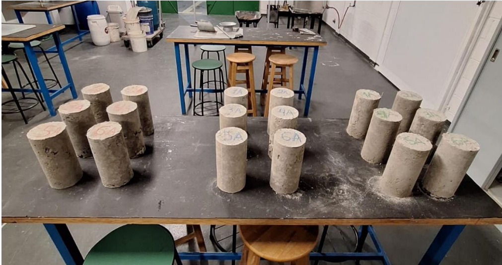
Figura 6 - Foto após o processo de cura de 28 dias (Fonte: Próprios autores).
