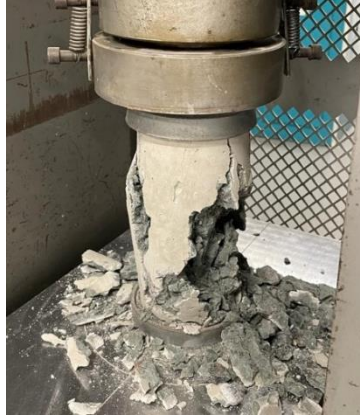
Figura 11 - Foto do ensaio de compressão do traço de concreto de referência (Fonte: Próprios Autores).
