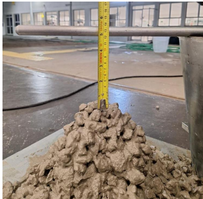
Figura 7 - Foto do teste de slump do traço de concreto de referência (Fonte: Próprios autores).
