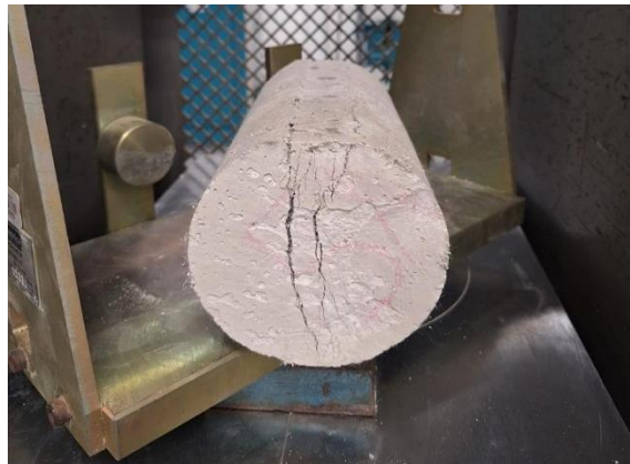
Figura 16 - Foto do ensaio de tração por compressão na diametral do traço de concreto com fibras de polipropileno (Fonte: Próprios Autores).
