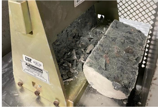
Figura 15 - Foto do ensaio de tração por compressão na diametral do traço de concreto de referência (Fonte: Próprios Autores).
