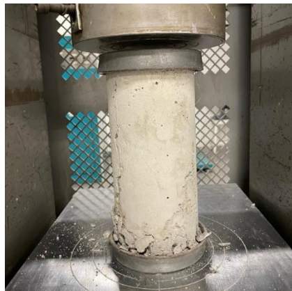
Figura 13 - Foto do ensaio de compressão do traço de concreto com fibra de coco (Fonte: Próprios Autores).
