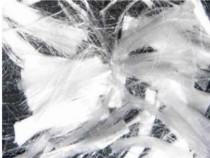
Figura 1 - Ilustração da microfibra de polipropileno do tipo microfibra (Fonte: NTC Brasil).
