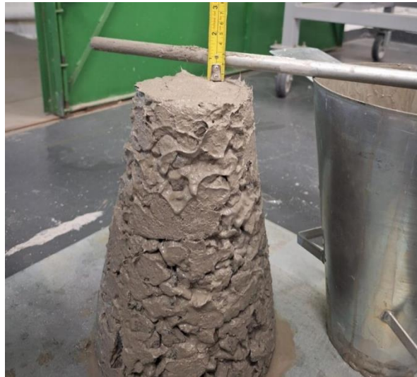
Figura 8 - Foto do teste de slump do traço do concreto com fibra de polipropileno (Fonte: Próprios autores).
