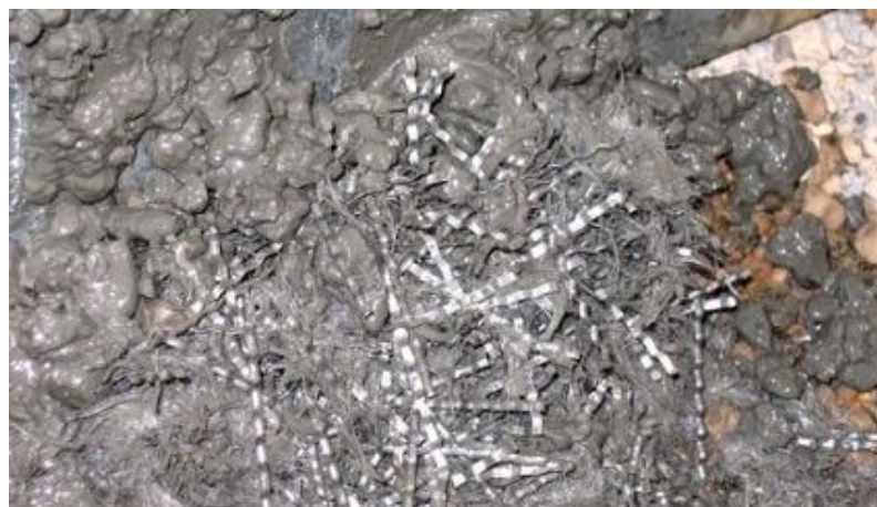
Figura 2 - Ilustração da macrofibra de polipropileno aplicada no concreto (Fonte: NTC Brasil)
