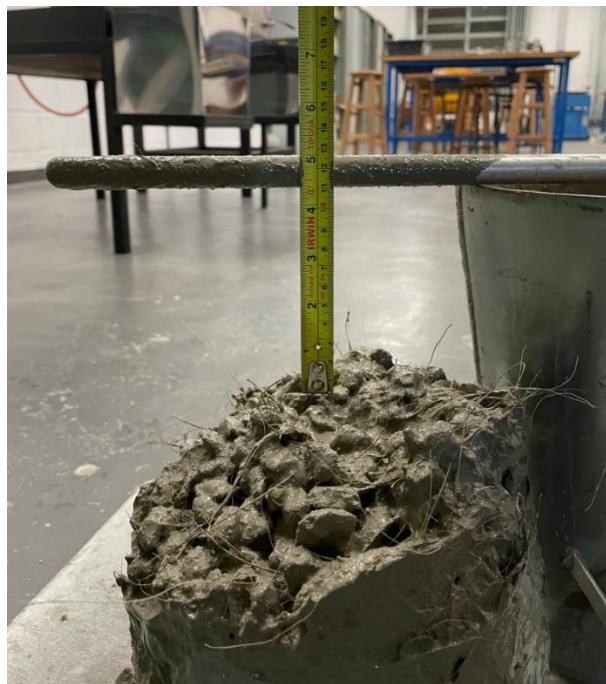
Figura 9 - Foto do teste de slump do traço do concreto com fibra de coco (Fonte: Próprios Autores).
