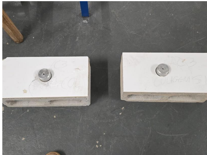
Imagem 7: CP com pastilhas coladas, aguardando arrancamento
