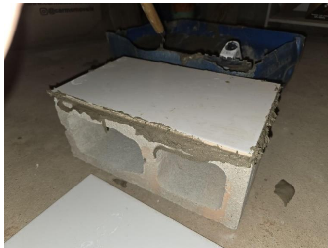
Imagem 5: Cerâmica assentada no CP, a argamassa ultrapassa as bordas da cerâmica durante o assentamento da peça.
