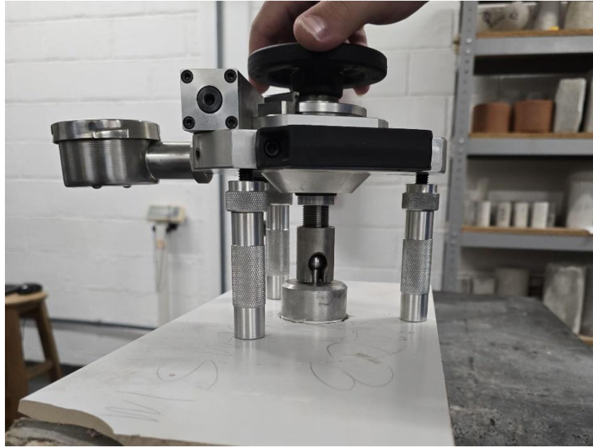
Imagem 8: Aparelho posicionado, pronto para iniciar teste de arrancamento.
