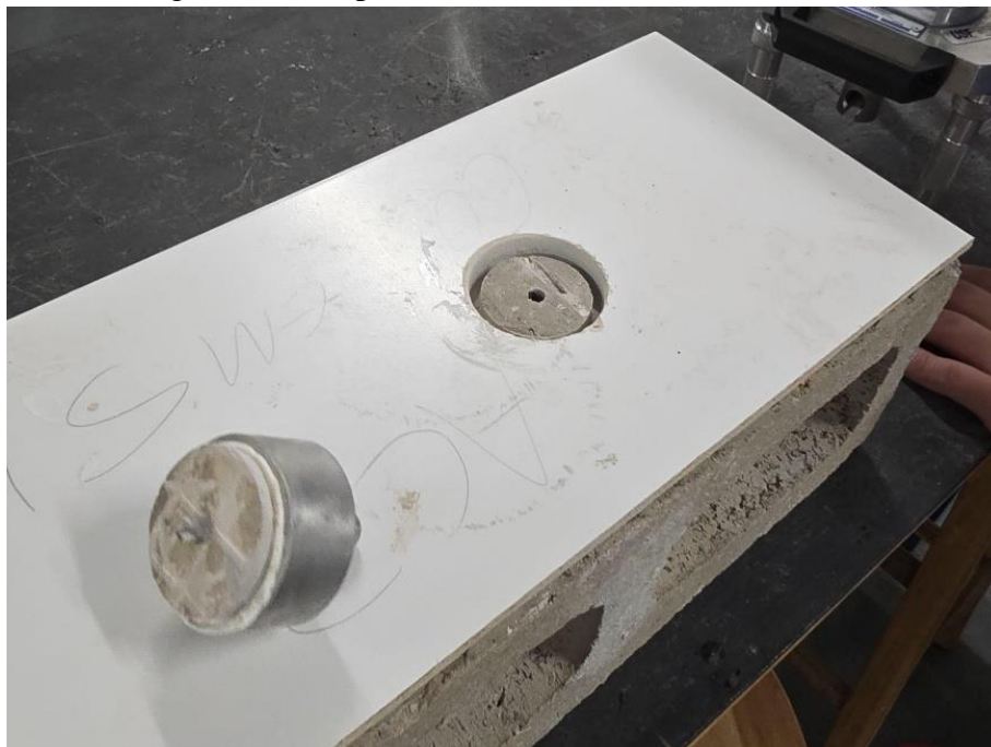
Imagem 9: Exemplo de teste de arrancamento realizado
