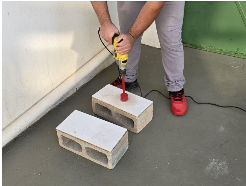
Imagem 6: Preparação do CP; furo com serra-copo
