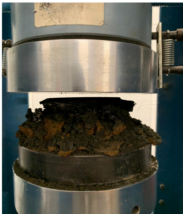
FIGURA 13 - Corpo de Prova 3 sendo rompido
