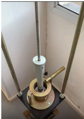
FIGURA 4 - Equipamento compactador manual Mini Marshall
