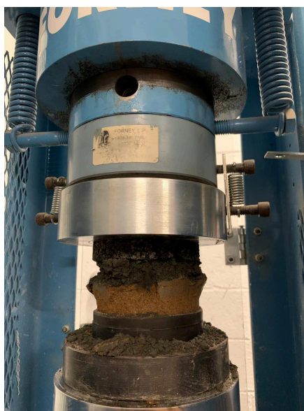
FIGURA 14 - Corpo de Prova 4 sendo rompido
