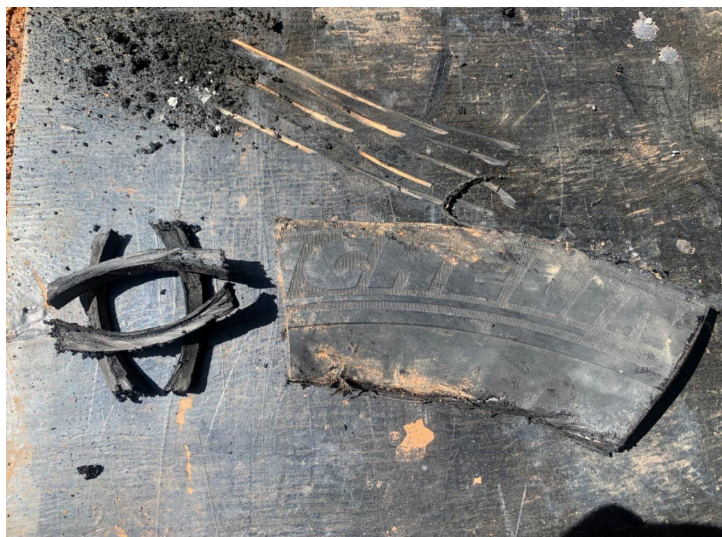
FIGURA 2 - Pneu já cortado em tiras. Fonte: Os autores
