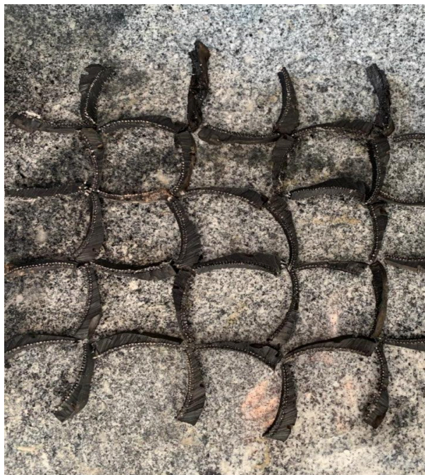
FIGURA 3 - Geogrelha criada através da emenda das borrachas
