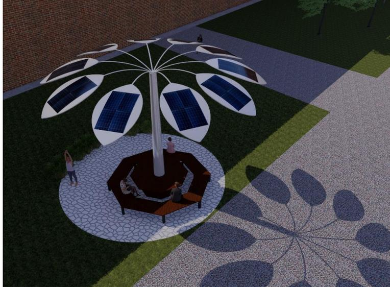
A *Power Tree* contará com 10 ramificações com módulos fotovoltaicos, um tronco de material de fibra de vidro e 10 tomadas para o carregamento dos dispositivos eletrônicos, seu banco e sua mesa será de madeira. A árvore contém um dimensionamento de 10 metros de altura e 8,5m de largura, as placas fotovoltaicas possuem 2,080m de altura, 1,030m de largura e 0,035m de espessura.
