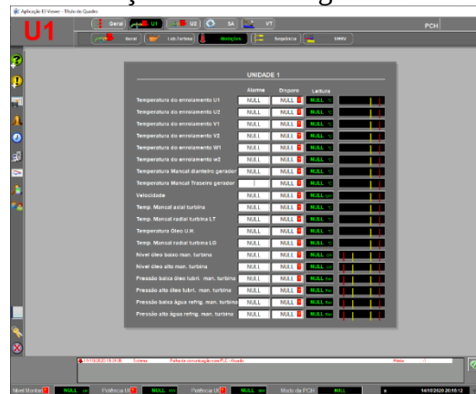
Figura 5 – Tela de medições da unidade geradora no sistema clássico
