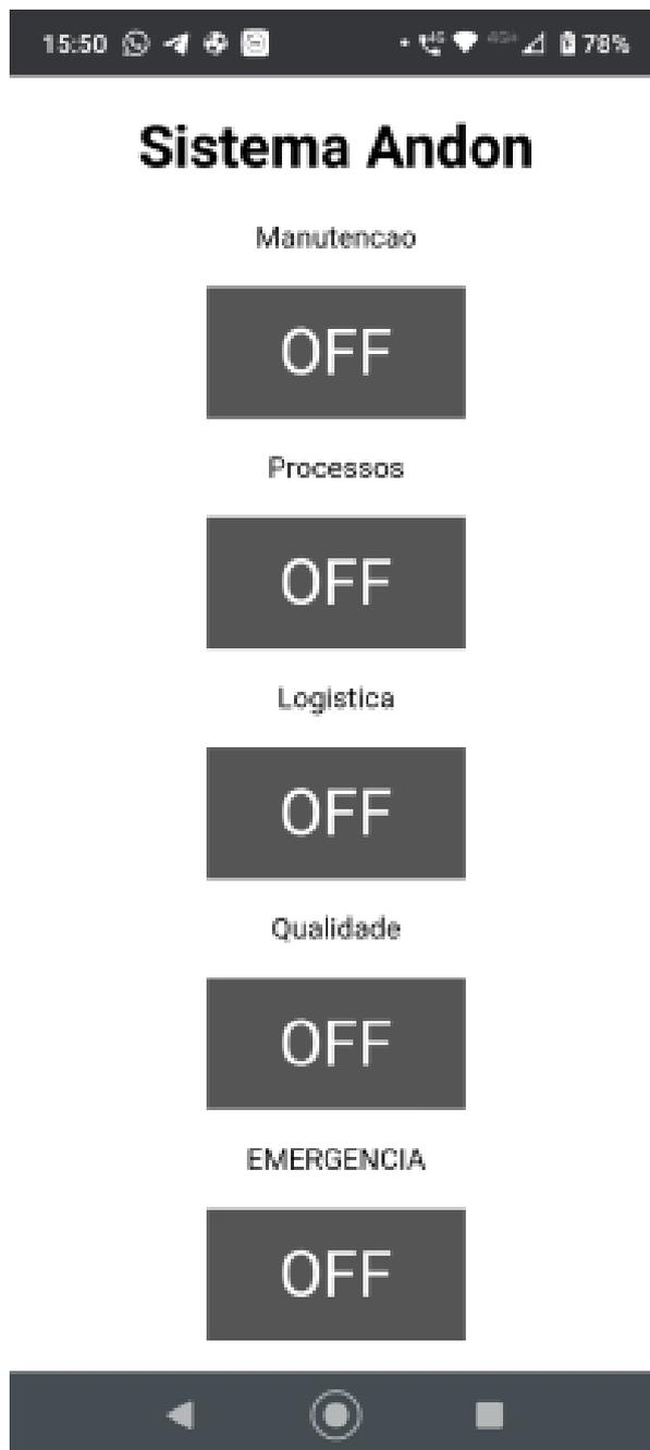
Através dessa *interface*, o usuário pode solicitar o auxílio para uma área determinada ou indicar um estado de emergência na operação. Com a solicitação feita, o sistema manda automaticamente uma mensagem via *Telegram* para um usuário previamente determinado no código fonte inserido no ESP32. Conforme mostra figura 13, foi solicitado assistência da
