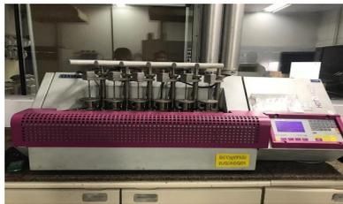
**Figura 14.** Equipamento de análise de deflexão térmica (CEAST) (Fonte: Própria).
