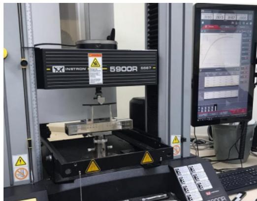
**Figura 11.** Máquina Universal realizando ensaio de flexão (Fonte: Própria).
