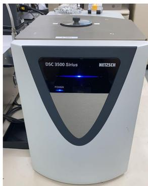
**Figura 15.** Equipamento DSC 3500 Sirius (Fonte: Própria).
