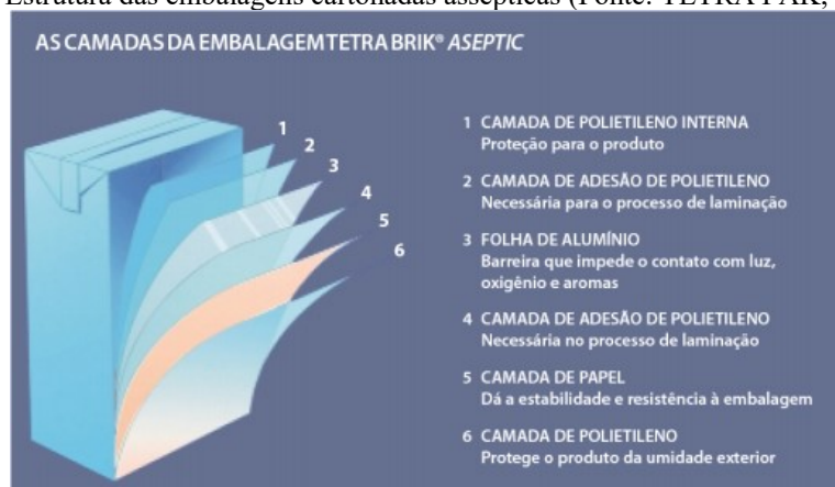
Figura 7 – Estrutura das embalagens cartonadas assépticas (Fonte: TETRA PAK, 2006).
