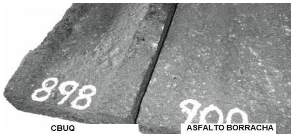
Figura 5: Placa de CBUQ e asfalto-borracha após ensaio de simulação de tráfego (Fonte: Silva, 2018).
