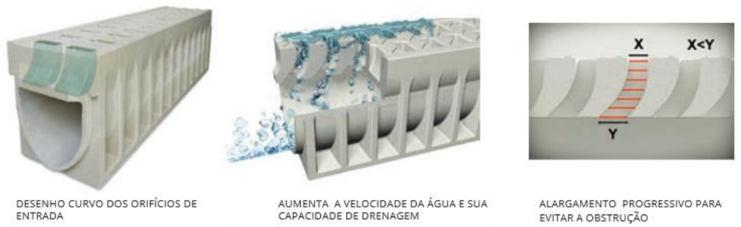
Figura 3 – Representação da tecnologia de drenagem Max Flow (Fonte: ULMA, 2020).
