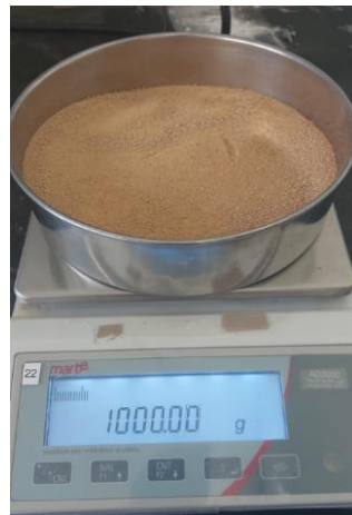
Figura 5— separação de 1kg de solo destorroado (Fonte: Próprio autor).
