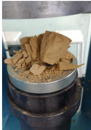
Figura 20— Um corpo de prova rompido de traço padrão (Fonte: Próprio autor).
