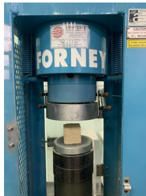
Figura 18 – Teste de resistência à compressão (Fonte: Próprio autor).
