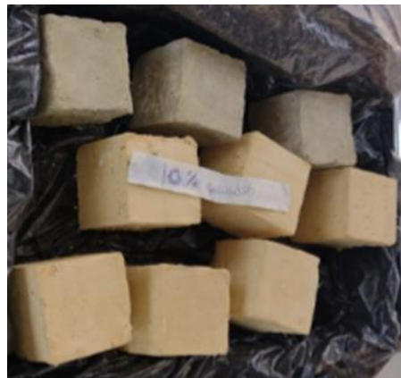
Figura 16— Corpos de prova com 10% de cinzas (Fonte: Próprio autor).
