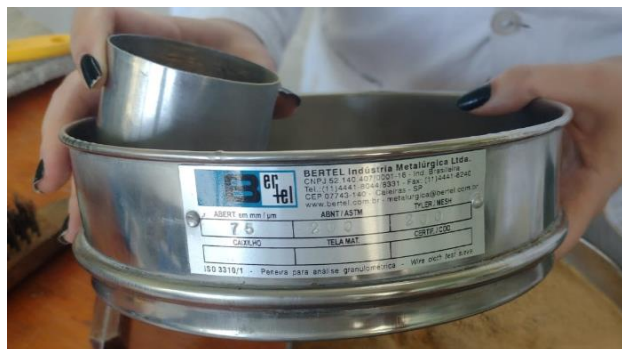
Figura 6— Amostra de 1kg sendo passada na peneira de 2mm (Fonte: Próprio autor).
