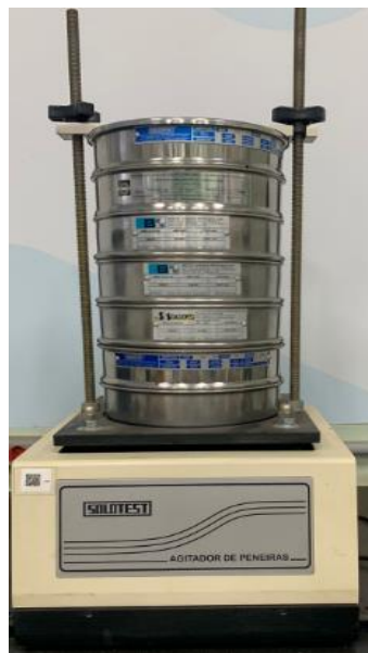
Figura 9— Conjunto de peneiras com a amostra no agitador mecânico (Fonte: Próprio autor).
