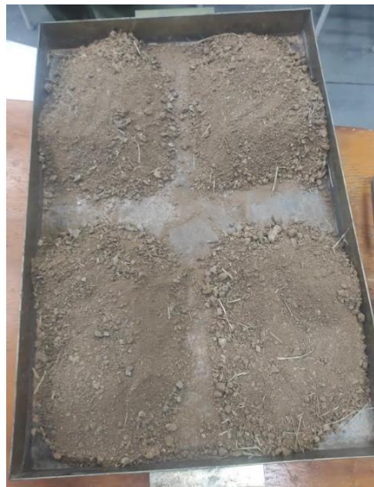
Figura 05: Quarteamento do material, Universidade São Francisco, Campinas, São Paulo (Fonte: Próprio autor).
