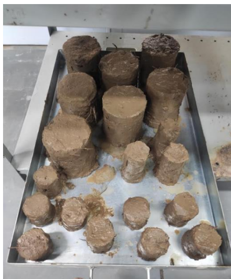
Figura 07: Corpos de prova moldados, Universidade São Francisco, Campinas, São Paulo (Fonte: Próprio autor).
