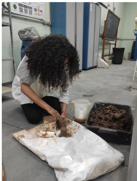
Figura 06: Moldagens dos corpos de prova, Universidade São Francisco, Campinas, São Paulo (Fonte: Próprio autor).
