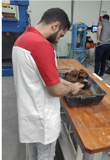
Figura 10: Desmanche dos torrões, Universidade São Francisco, Campinas, São Paulo (Fonte: Próprio autor).
