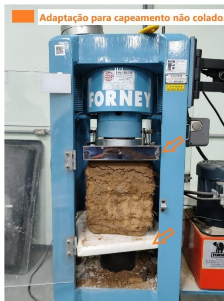
Figura 04: Amostra da prensa e tentativa do capeamento não colado, Universidade São Francisco, Campinas, São Paulo (Fonte: Próprio autor - 2023).
