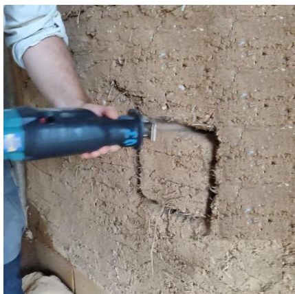
Figura 01: Extração do corpo de prova, São Roque, São Paulo (Fonte: Próprio autor - 2023).
