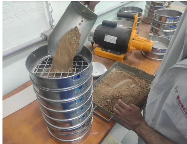
Figura 13: Inclusão do material nas peneiras, Universidade São Francisco, Campinas, São Paulo (Fonte: Próprio autor).
