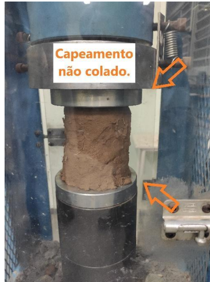
Figura 08: Capeamento não colado, Universidade São Francisco, Campinas, São Paulo (Fonte: Próprio autor).
