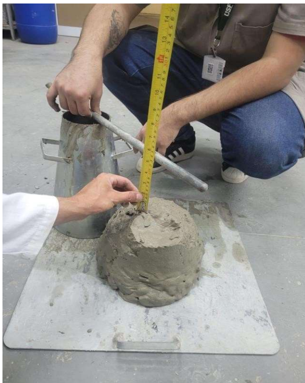
Imagem 5 – Medição do abatimento realizado com trena (Fonte: Proprio autor).
