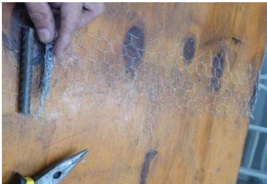
Imagem 8 – Comparação de Tela Galvanizada e Armação Convencional (Fonte: Proprio autor).
