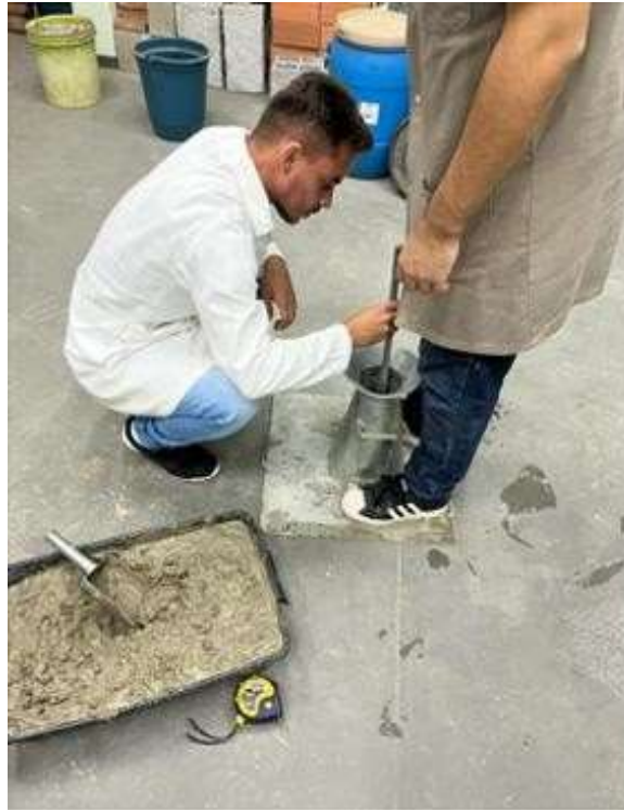
Imagem 4 – Teste de Slump (Fonte: Proprio autor).
