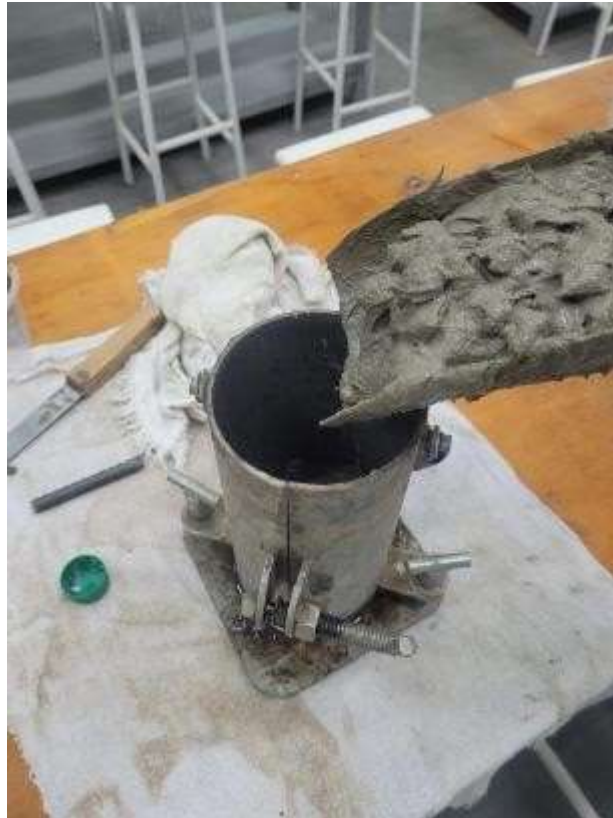
Imagem 6 – Preenchimento do Cilindro com Concreto (Fonte: Proprio autor).
