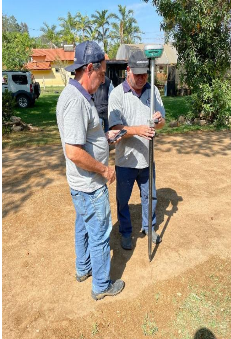
Figura 3: Posicionamento do equipamento R90i GNSS no primeiro ponto
