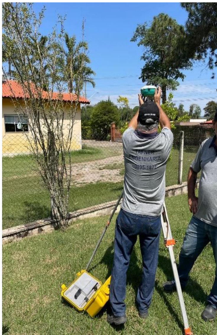
Figura 2: Montagem do equipamento R90i GNSS
