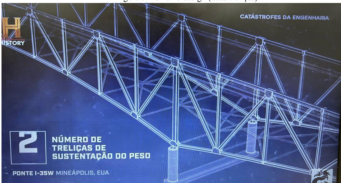
Figura 5: Falha no design (duas treliças)
