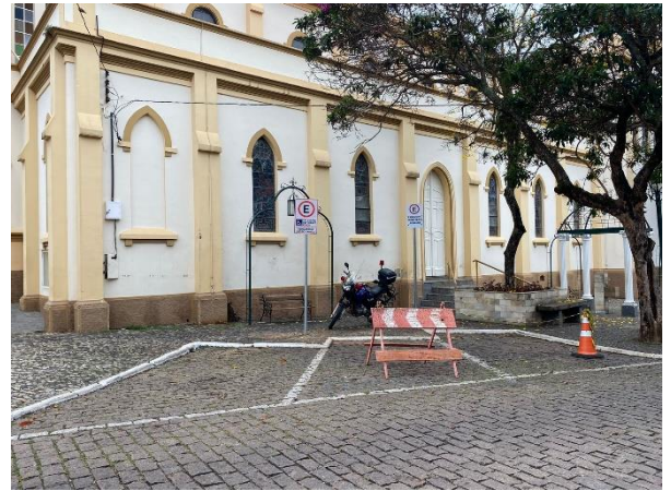
Figura 12: Vaga de deficiente sem sinalização horizontal e sem espaço adicional ou próxima a faixa de travessia de pedestres.
