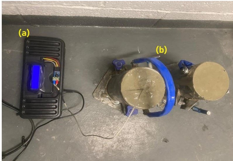
Imagem 4 – Dispositivo realizando leitura das temperaturas do corpo de prova
