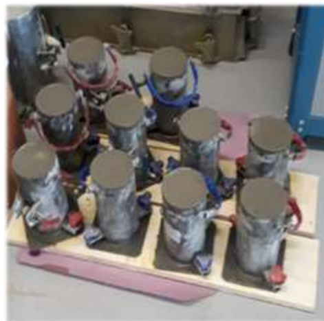
Figura 13: Corpos de provas em processo de cura - (Fonte: Próprio autor).
