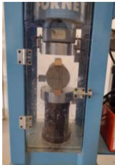
Figura 16: Corpo de prova preparado para receber carga, no ensaio de tração por compressão diametral - (Fonte: Próprio autor).
