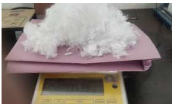
Figura 3: Fibras de polipropileno separadas e pesadas na proporção especificada para o volume de concreto – (Fonte: Próprio Autor).
