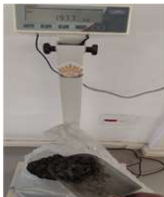
Figura 8: Materiais sendo fracionados em função de sua massa, para o traço pré-determinado - (Fonte: Próprio autor).
