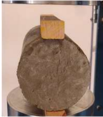
Figura 19: Corpo de prova de concreto com adição de fibras de polipropileno, fissurado após ensaio de Resistência de tração por compressão diametral – (Fonte: Próprio autor).
