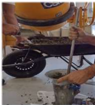
Figura 11: Molde para corpo de prova de 10x20 cm, sendo preenchido com massa de concreto - (Fonte: Próprio autor).
