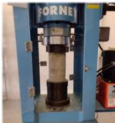
Figura 15: Corpo de prova sendo preparado para receber carga, no ensaio de compressão - (Fonte: Próprio autor).
