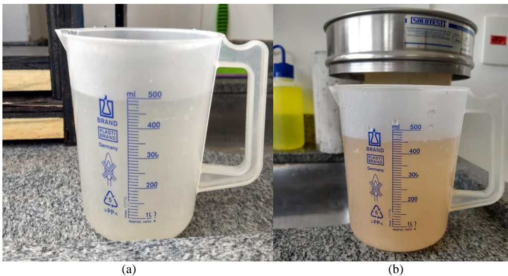
Figura 15 - Resultados obtidos da absorção (a) teste com brita1; (b) teste com RCCs. Fonte: Próprio autor
