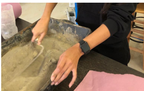
Figura 03 - Misturando a medida de cimento na areia - (Fonte: Próprios autores).
