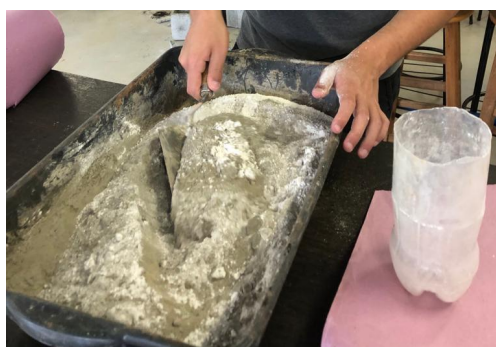
Figura 04 - Misturando a medida de cal, na mistura de cimento e areia - (Fonte: Próprios autores).
