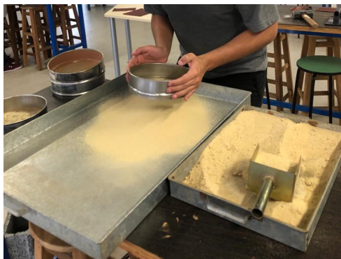
Figura 02 - Peneirando a areia - (Fonte: Próprios autores).
