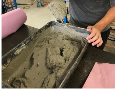
Figura 05 - Argamassa pronta para preparar as superfícies - (Fonte: Próprios autores).
