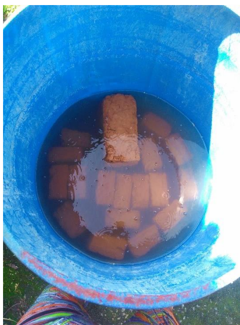
Figura 11: Imersão dos tijolos ecológicos (Fonte: O autor)
