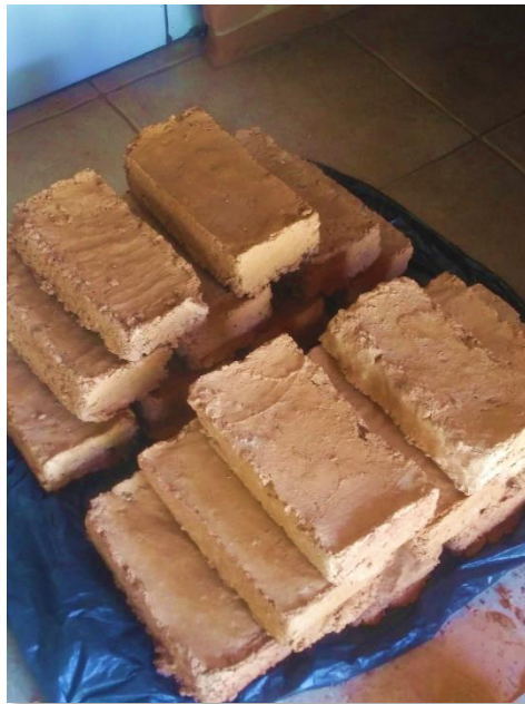
Figura 9: Tijolos Ecológicos (Fonte: O autor)
