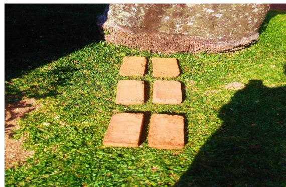
Figura 13: Amostras secando no ar livre (Fonte: O autor)
