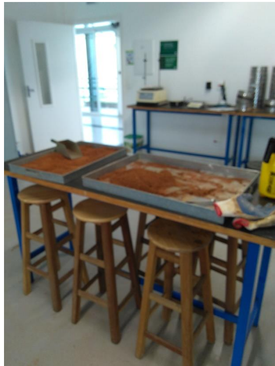
ANEXO J: Preparo da amostra para a compactação 13/09/2022 (Fonte: o autor)
