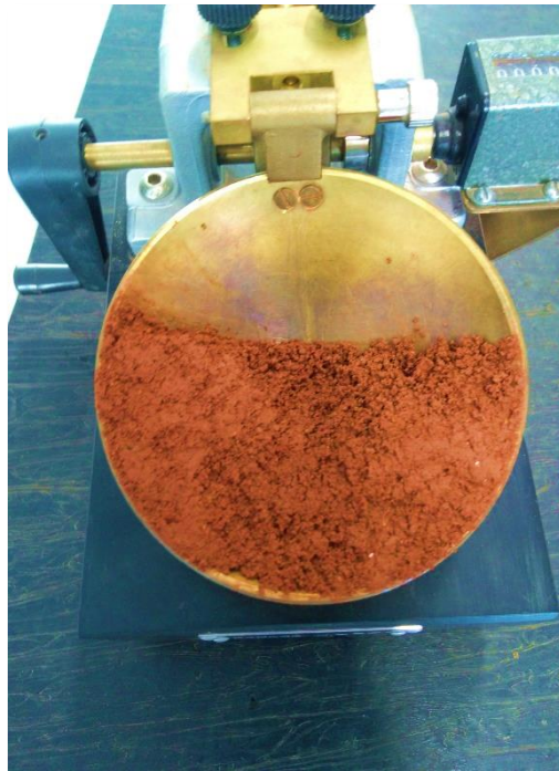
ANEXO F:Amostra na concha do aparelho de casa grande 06/09/2022 (Fonte: o autor)
