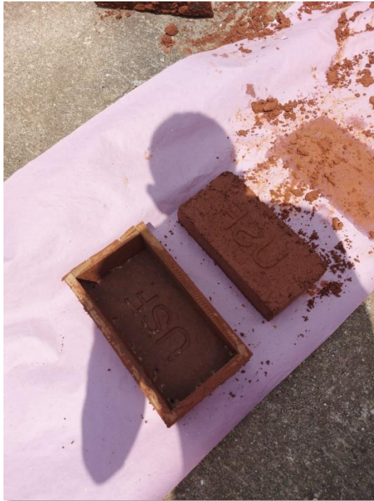
ANEXO O: Processo de confecção dos tijolos ecológicos 07/10/2022 (Fonte: o autor)
