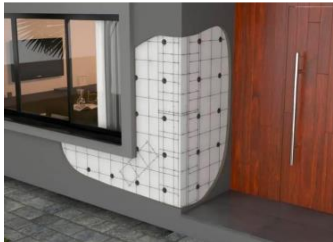
Figura 20 – Revestimento de um painel monolítico (Fonte: ISORECORT)
