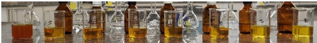
**Figura 13** - Coloração ensaio cinética CAA - Da esquerda para direita: amostra padrão e 5 minutos até 60 minutos.
