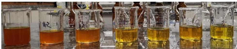
**Figura 15** - Coloração ensaio isoterma CAA - Da esquerda para direita: amostra padrão e 0,2 gramas até 2,5 gramas.
