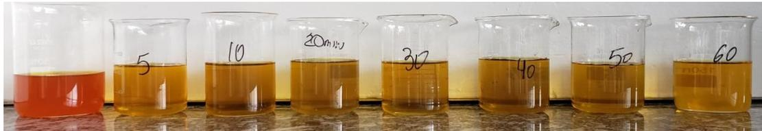
**Figura 12** - Coloração ensaio cinética CAC - Da esquerda para direita: amostra padrão e 5 minutos até 60 minutos.
