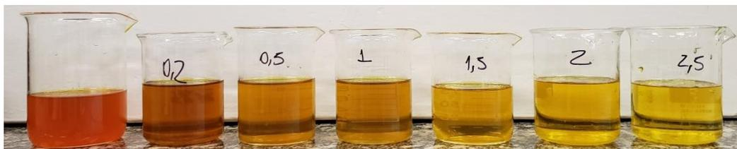
**Figura 14** - Coloração ensaio isoterma CAC - Da esquerda para direita: amostra padrão e 0,2 gramas até 2,5 gramas.
