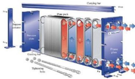
**Figura 4** - Esquema do funcionamento do trocador de calor de placas (Fonte: [http://www.ufjf.br/washington\\_irrazabal/files/2014/05/Aula-23\\_Trocadores-de-Calor.pdf](http://www.ufjf.br/washington_irrazabal/files/2014/05/Aula-23_Trocadores-de-Calor.pdf)).
