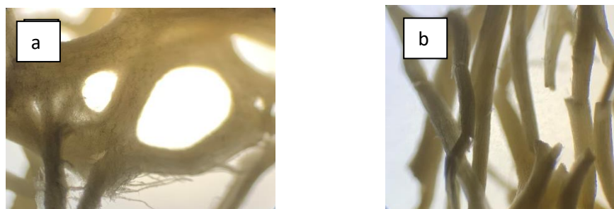
Figura 6. Visão microscópica do adsorvente: em a bucha antes de ser ativada em meio ácido, em b representação de bucha ativada com HCl e seca em estufa por 24 horas.
