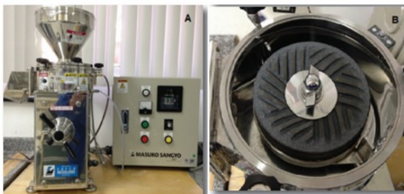
Figura 10. (A) Moinho Super Masscolloider MKCA6-2J (Masuko Sangyo). (B) Pedra de moagem inferior móvel do Moinho Super Masscolloider. Fonte: (MAGALHÃES, 2017).
