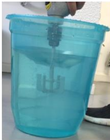
Figura 18. Teste do impelidor do tipo âncora em recipiente translúcido.
