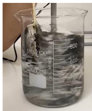
Figura 23. Corrente Axial visualizada lateralmente.
