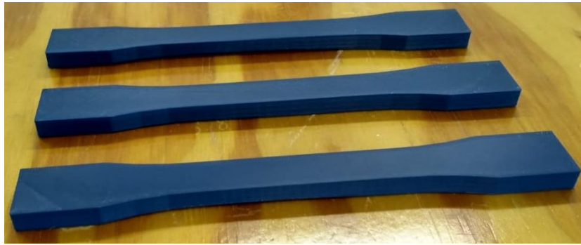
Figura 14. Corpos de prova impressos em ABS.
