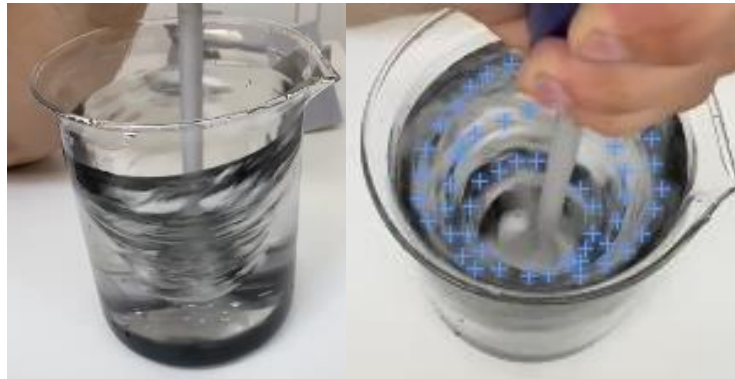
Figura 21. A) Vórtice no sistema. b) Vórtice sequenciado pelo Software Kinovea®.
