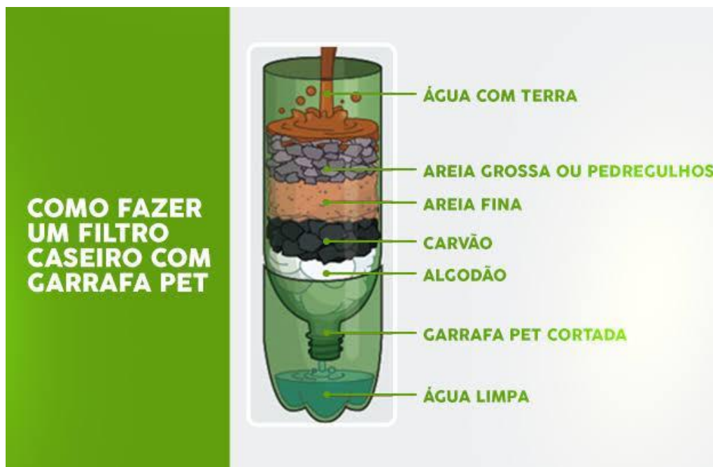
Figura 04: Esquema Filtro de água caseiro com garrafa pet.
