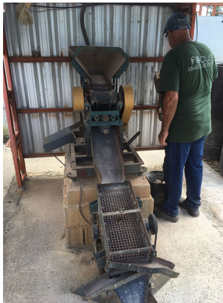
Figura 06: Maquete para trituração e reciclagem de RCD.
