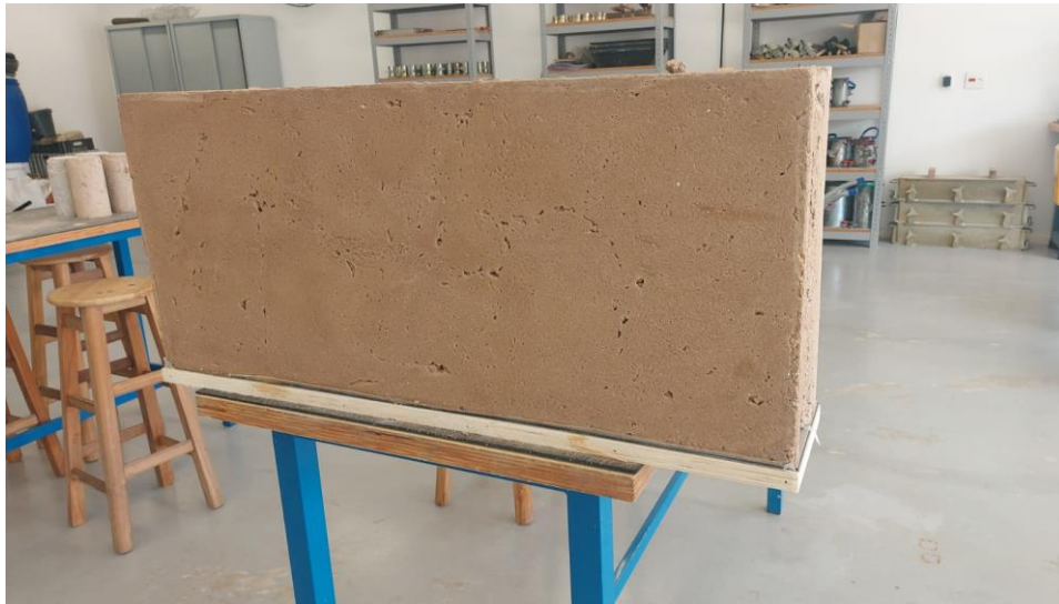
Figura 10 – Elemento estrutural com cobertura de argamassa alternativa (Fonte: Autoria própria) (2021).
