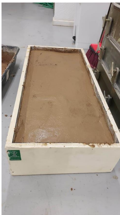
Figura 9 – Blocos assentados com argamassa alternativa dentro da forma (Fonte: Autoria própria) (2021).
