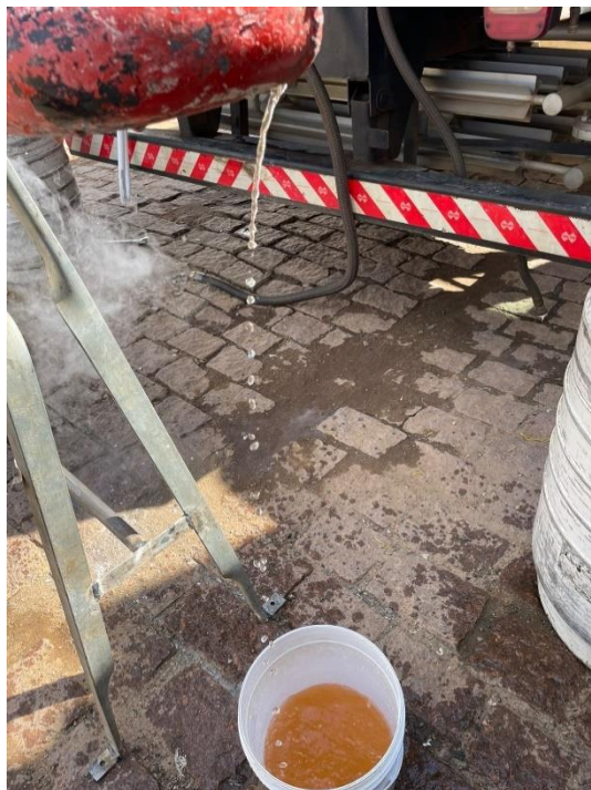
Figura 10: Drenagem de água após congelamento.
