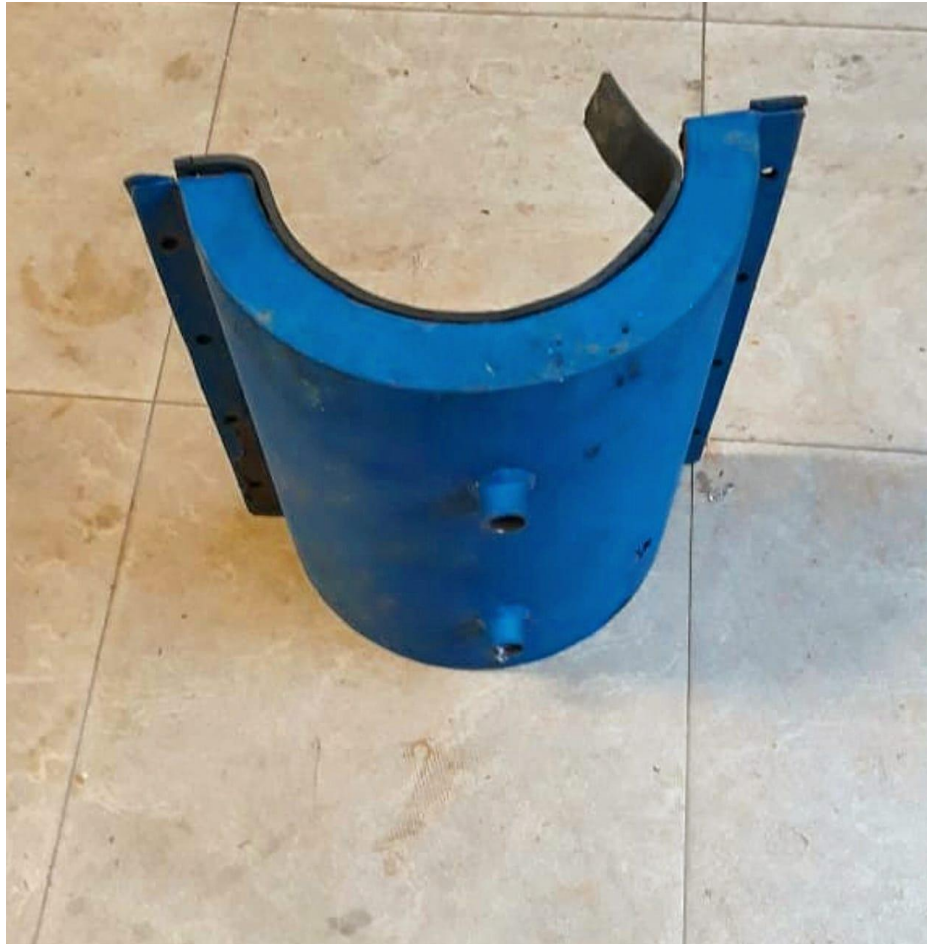
Figura 4: Camisa utilizada em congelamentos hidráulicos
