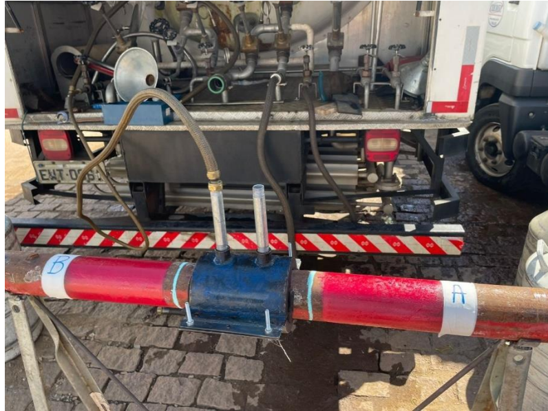
Figura 5: Montagem da camisa com indicação de marcação e lados.
