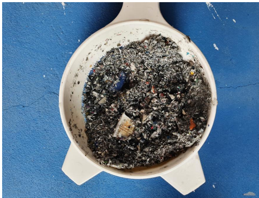
Figura 9 – Foto da peneira com resíduos flutuantes da estação de tratamento da empresa Primeplas, Itatiba, São Paulo.
