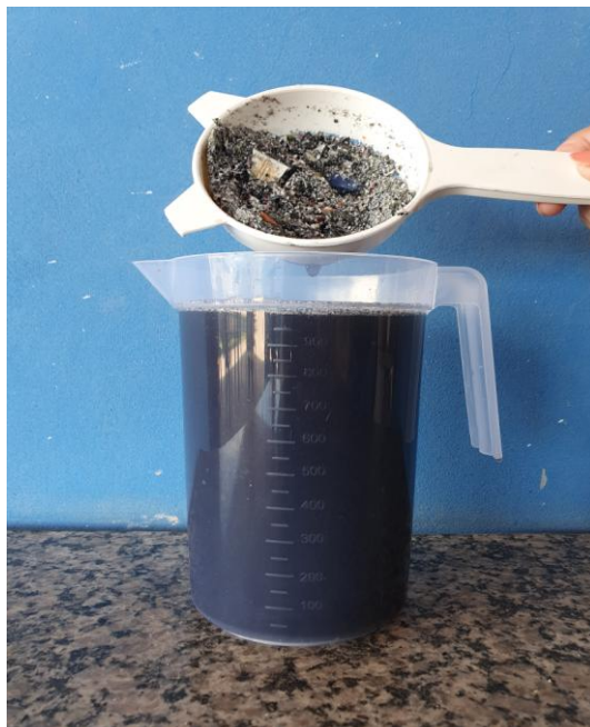
Figura 05 – Foto da peneira com o resíduo sólido, e água para teste da estação de tratamento da empresa.
