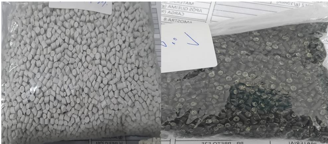
Figura 4: Foto de matérias de teste, Pellets branco natural e preto com pigmentação em pó da empresa Primeplas, Itatiba, São Paulo.
