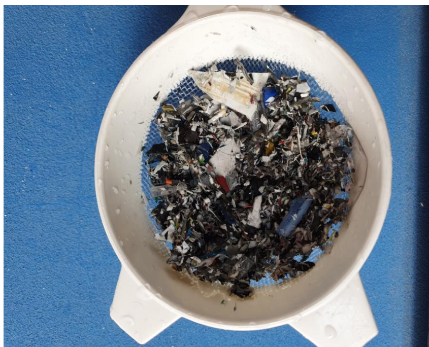
Figura 10 – Foto da peneira com resíduos pós lavagem e agitação da empresa Primeplas, Itatiba, São Paulo
